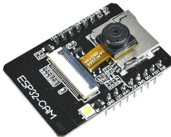
FIGURE 4 – Carte ESP32 avec caméra 2MP et carte SD
